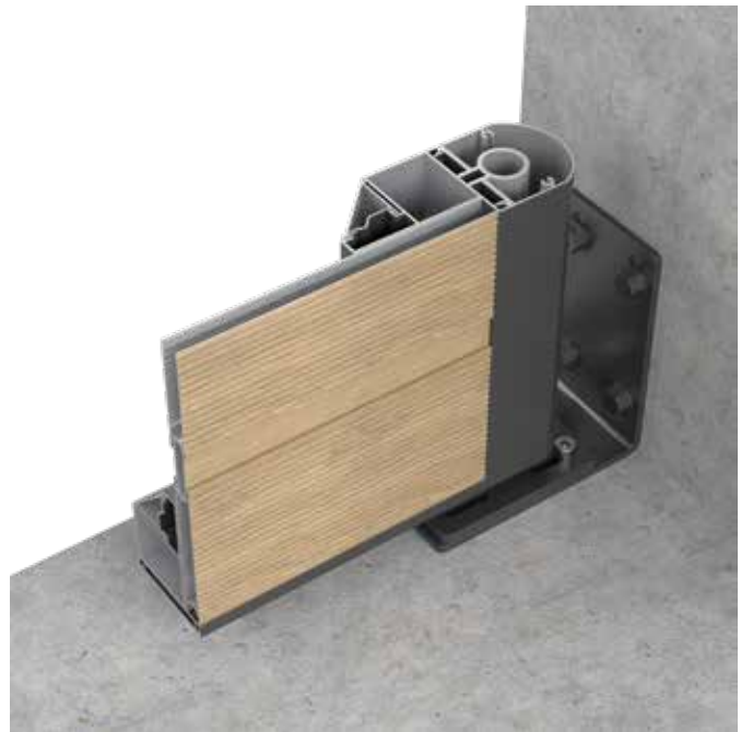
Vues détaillées, supérieure et inférieure, des châssis et profilés rainurés, ainsi que profile de l'axe de pivotement avec INOX 316 GOND qui supporte 250 Kg chacun. Le châssis de portail à un vantreau maximum est proche de 4 m 2 et résiste à une charge de vent maximum de 2KPa.
